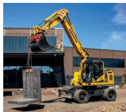
Système anti-tangage de la flèche (ECSS) pour un déplacement plus confortable
