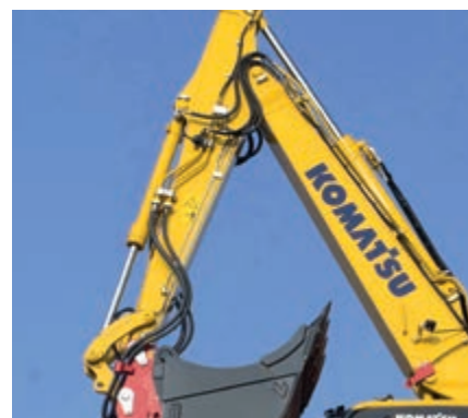
Nouvelle disposition uniforme des systèmes HCU pour toutes longueurs de balancier
