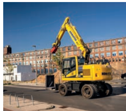
Système anti-tangage de la flèche (ECSS) pour un déplacement plus confortable
