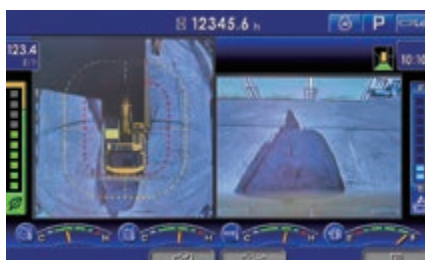
Avec KomVision, les différentes caméras vous offrent une vue aérienne constante de la machine
