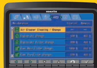
Écran de base de maintenance
