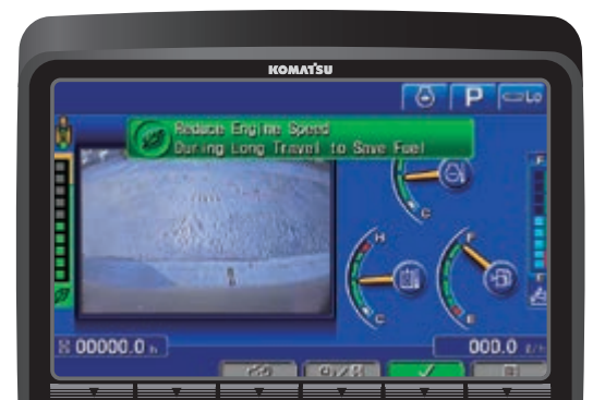
Le moniteur amélioré affiche l'image de la caméra arrière sur l'écran, par défaut. La jauge éco, les conseils éco, l'indicateur de consommation de carburant et l'arrêt automatique réglable en cas d'inactivité aident l'opérateur à réduire davantage la consommation de carburant.
