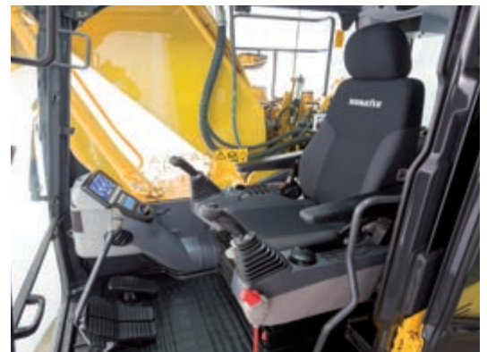
Le poste de commande à suspension pneumatique intégrale assure un confort maximum à l'opérateur.
