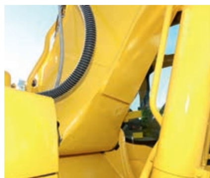
Pied de flèche en acier moulé et plaque de dessous de flèche d'une seule pièce
