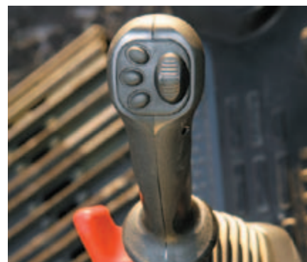
Manipulateurs avec boutons de commande proportionnels pour les accessoires en série
