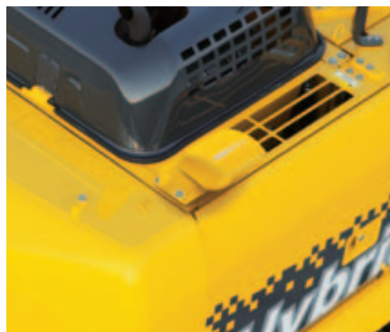
Caméra additionnelle, installée côté droit (en option)
