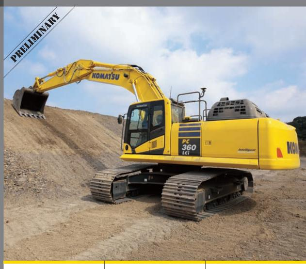
ENGINE POWER 202 kW / 271 HP @ 2.000 rpm **OPERATING WEIGHT** 35.600 - 36.200 kg **BUCKET CAPACITY** max. 2,66 m<sup>3</sup>
