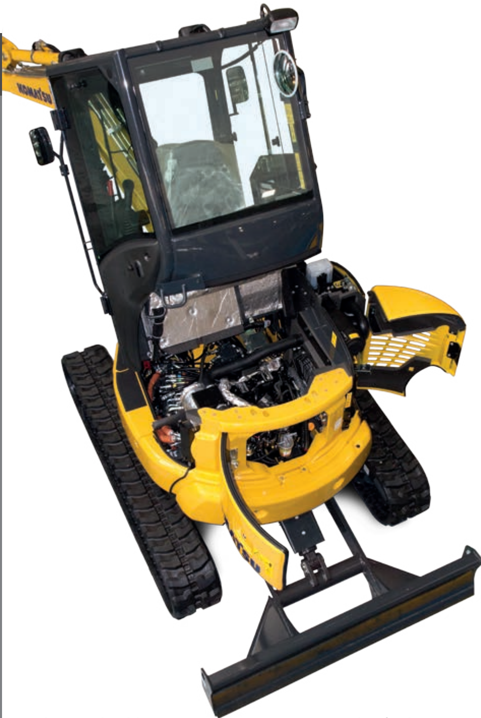
Capots arrière pour contrôle rapide des éléments du moteur, simple inspection et nettoyage des radiateurs et accès facilité à la batterie
