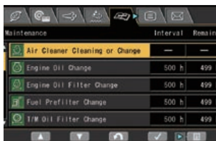
Un écran multifonctions affiche et contrôle de nombreuses informations d'utilisation et d'entretien
