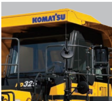
ROPS/FOPS conforme aux normes ISO 3471 ROPS et ISO 3449 FOPS Niveau 2
