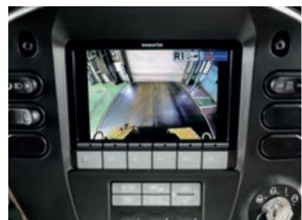
Système de caméra vue arrière complètement intégré
