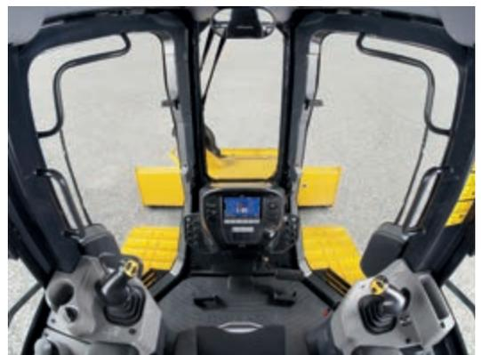
*Confort maximum pour l'opérateur et visibilité excellente sur la lame grâce au capot avant très incliné*
